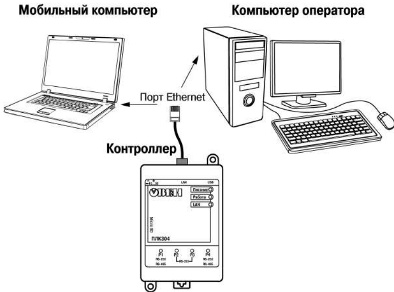
Рисунок 4.1 – Вариант подключения к ПК для программирования контроллера через порт Ethernet
