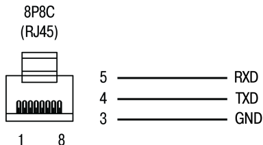
Рисунок Б.2 – Кабель связи ПЛК304 по RS-232 с внешним устройством
